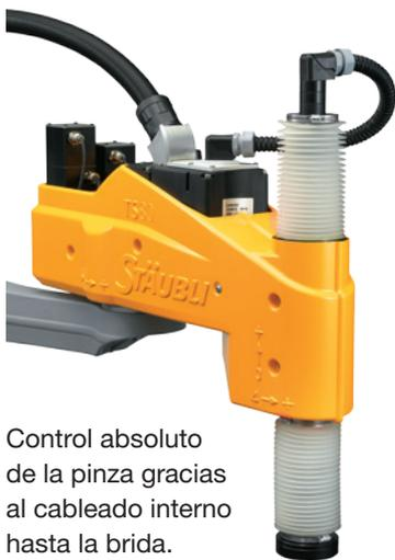
Control absoluto de la pinza gracias al cableado interno hasta la brida.
