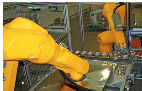
Mientras el robot RX160 manipula la bolsa del medicamento, el TX200 se encarga de las etapas de suministro y colocación de chapas metálicas provisionales.
