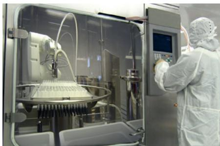
Aislador aseptico con brazo robótico de 6 ejes stericlean de Stäubli.
