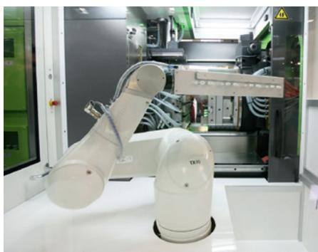
Robot TX90 cr dentro de una máquina de moldeado por inyección ENGEL Victory.
