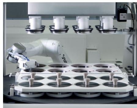
El ultra preciso robot TX60 cr realiza sin dificultad la manipulación química húmeda relacionada con implantes, 'stents' y jeringuillas.
